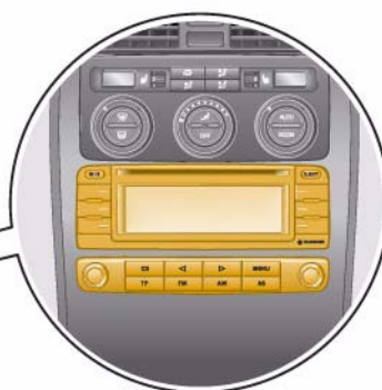
Блок управления с дисплеем для радио- и навигационной системы J503 или магнитола R в центральной консоли
