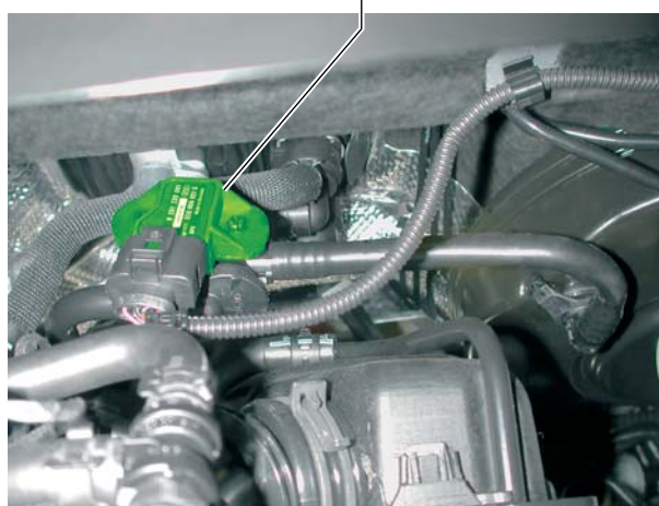
Датчик давления усилителя тормозов G294
