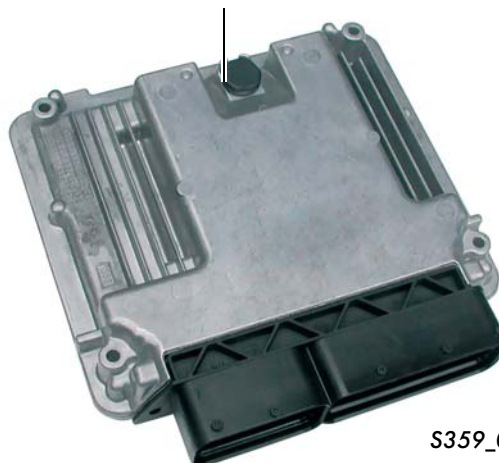
Блок управления двигателя с датчиком давления окружающей среды
