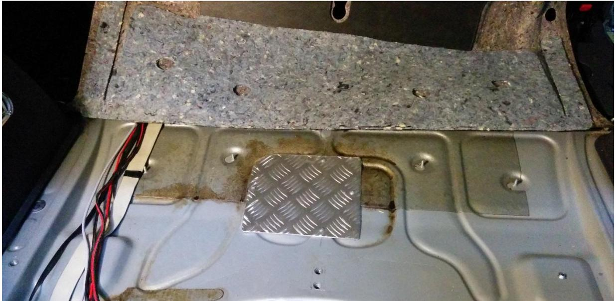
Края «раны» покрасил грунтовкой и промазал мовилем. Под саморезы положил плоские гайки вазовские. На дюральке, с обратной стороны наклеен кусочек шумки, входит в проем с натягом, чтобы перекрыть щели
