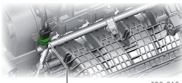
Датчик температуры и давления в газовой рампе GX21
