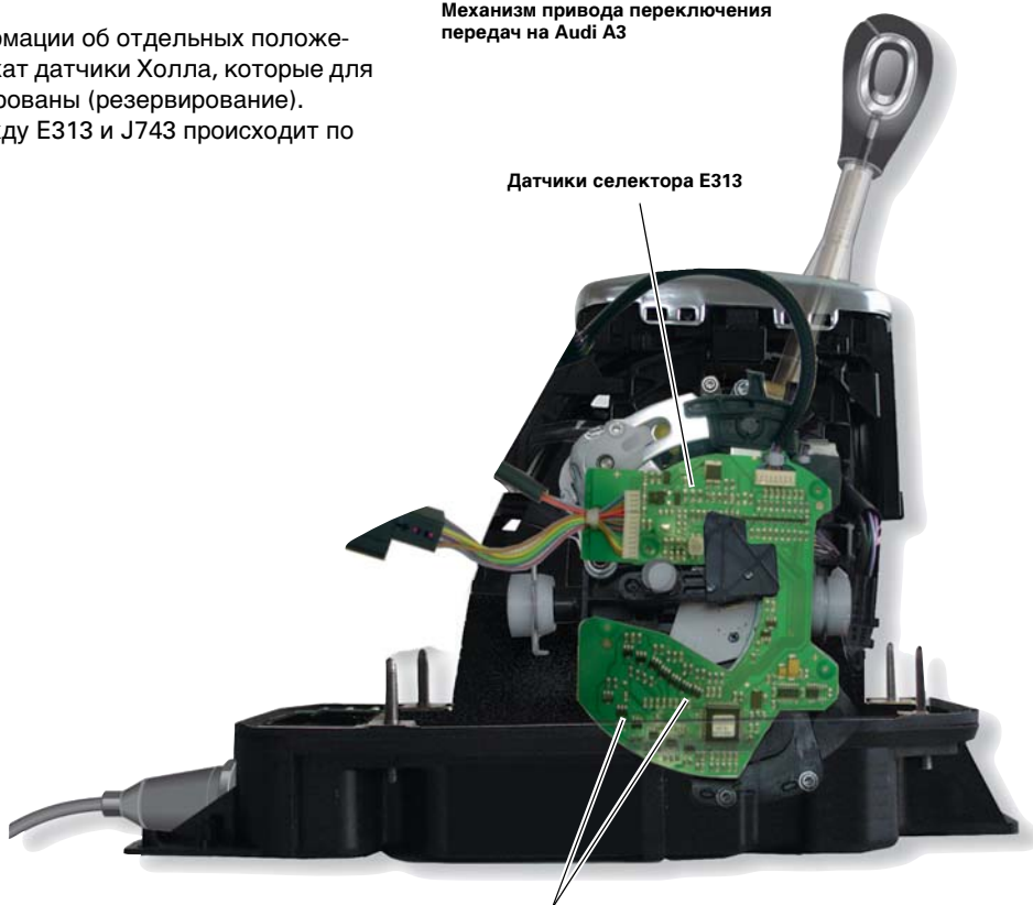
Датчики Холла для определения положений селектора P, R, N, D и S
